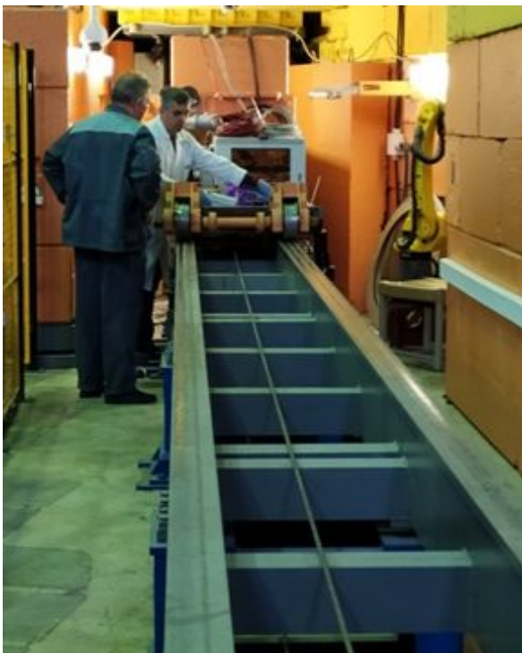
Рис. 6. Монтрование стенда для облучения на установке канала № 3 реактора ИБР-2 (цвет онлайн) Fig. 6. Mounting of the irradiation stand at the installation of channel № 3 of the IBR-2 reactor (color online)
