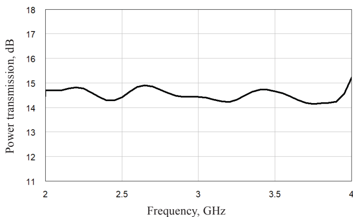
Рис. 10. Коэффициент усиления усилителя (дБ) Fig. 10. Amplifier gain (dB)
