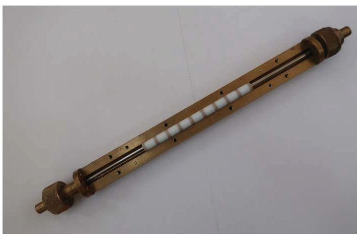
Рис. 6. Измерительная секция сверхвысокочастотной КБС Fig. 6. Measuring section of the microwave coaxial Bragg structure
