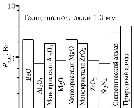
Рис. 1. Допустимый уровень мощности ( P_{\max} ) МПЛ, выполненных на подложках из различных материалов
