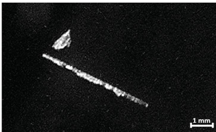
Рис. 6. Катодное свечение при автоэмиссионном токоотборе 900 А/см<sup>2</sup>
